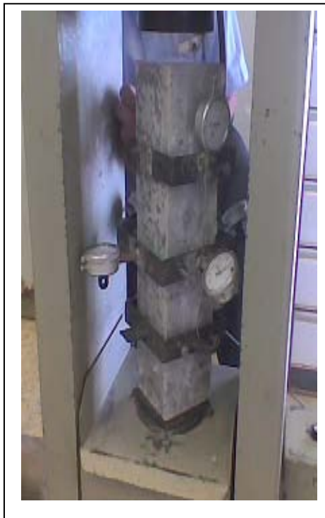
Photo 1: Essai de déformabilité sur éprouvette prismatique (10x10x40) cm 3 .
