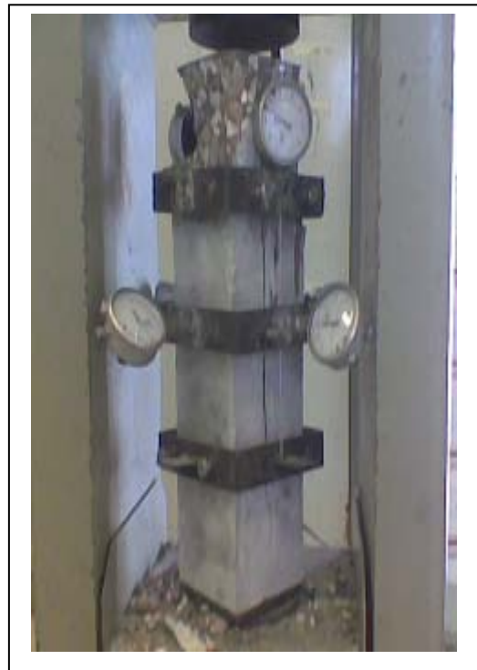
Photo 1: Essai de déformabilité sur éprouvette prismatique (10x10x40) cm 3 .
