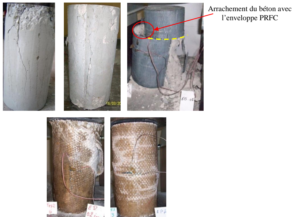
Figure 4. Faciès de rupture des colonnes en béton de contrôle et celles confinées par les enveloppes CFRP et GFRP ayant les orientations (0/90)_s , (+30/-60)_2 et (0/90)_2 respectivement.
